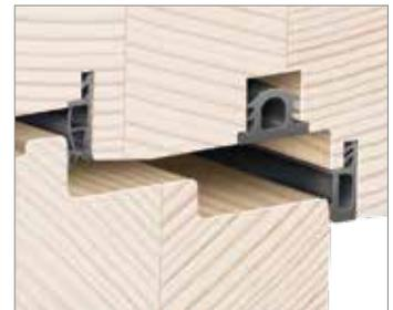
Die zusätzliche Dichtung im Flügelüberschlag optimiert die Dichtheit und verbessert die Schalldämmung.
